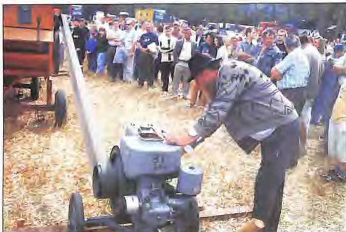
Skoszono zboże młócono młocarnią MSC 6 napędzaną przez silnik stacjonarny S - 60
