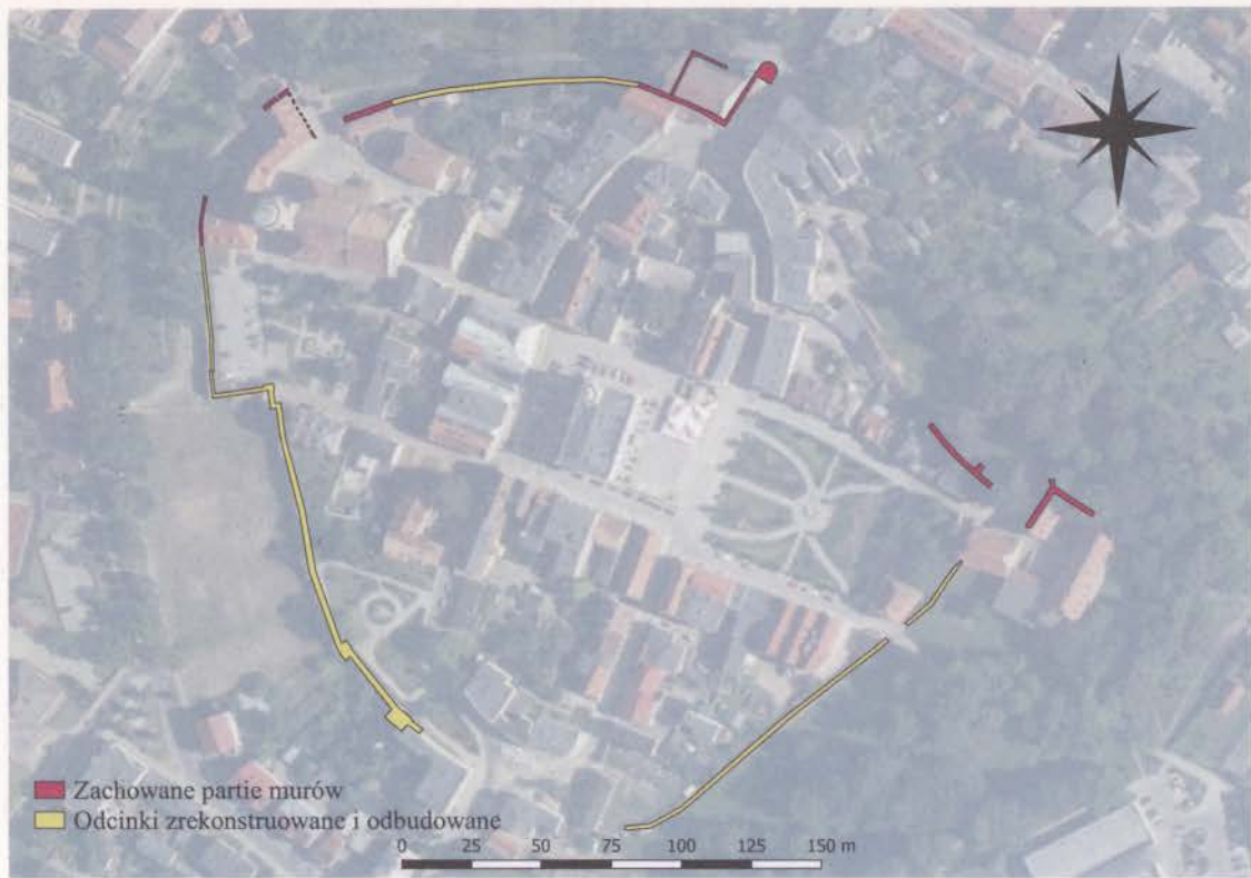
1. Stan zachowania substancji murowanej
